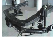
U biçimli elemanlarla De Dion dingil. Üst çerçeve, motor/transmisyon için yardımcı ikinci çerçeve.
